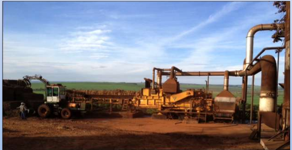
Picador de fardos de palha de cana, Usina da Pedra (Horta Nogueira, 2013)
